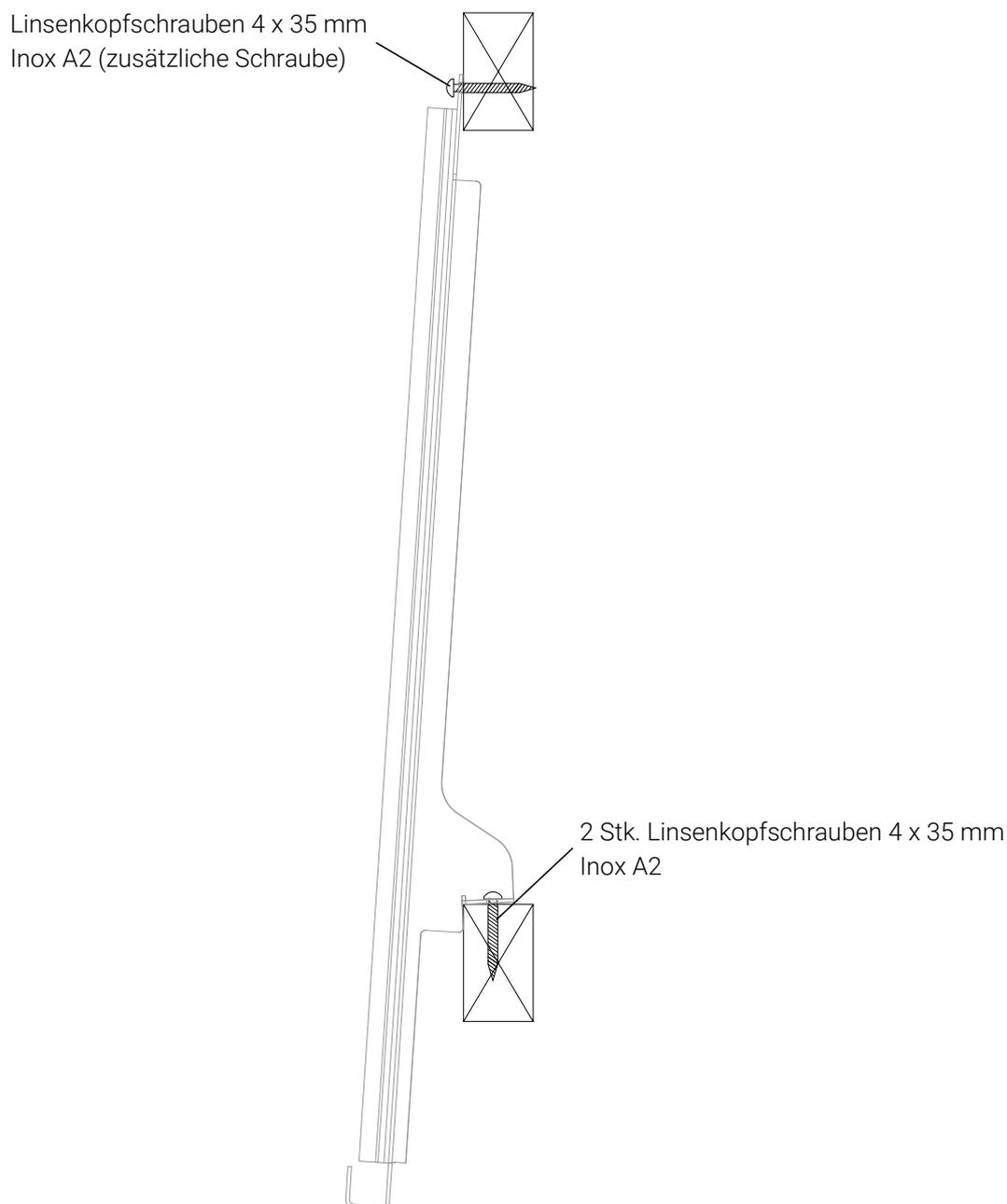
Die MATCH Haken werden jeweils mit 2 Schrauben auf der Dachlattung festgeschraubt. Die Schraube oben kann zusätzlich angebracht werden, empfohlen ist diese vor allem in den obersten Reihen und in den Randbereichen. Wir empfehlen die Dachlattung sowie die Konterlattung zu verschrauben. Die Statik des gesamten Dachaufbaus ist Sache des Unternehmers.
