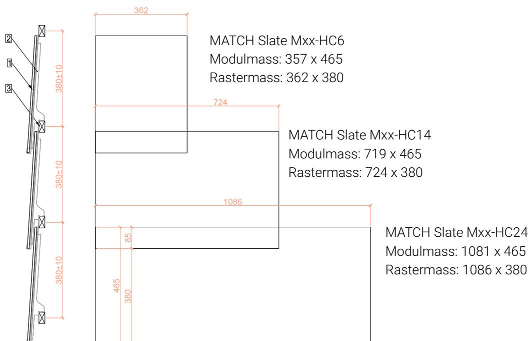
Das Rastermass der MATCH Slate Module ist in der Höhe 380 mm, es kann um  $\pm 10$  mm angepasst werden.
