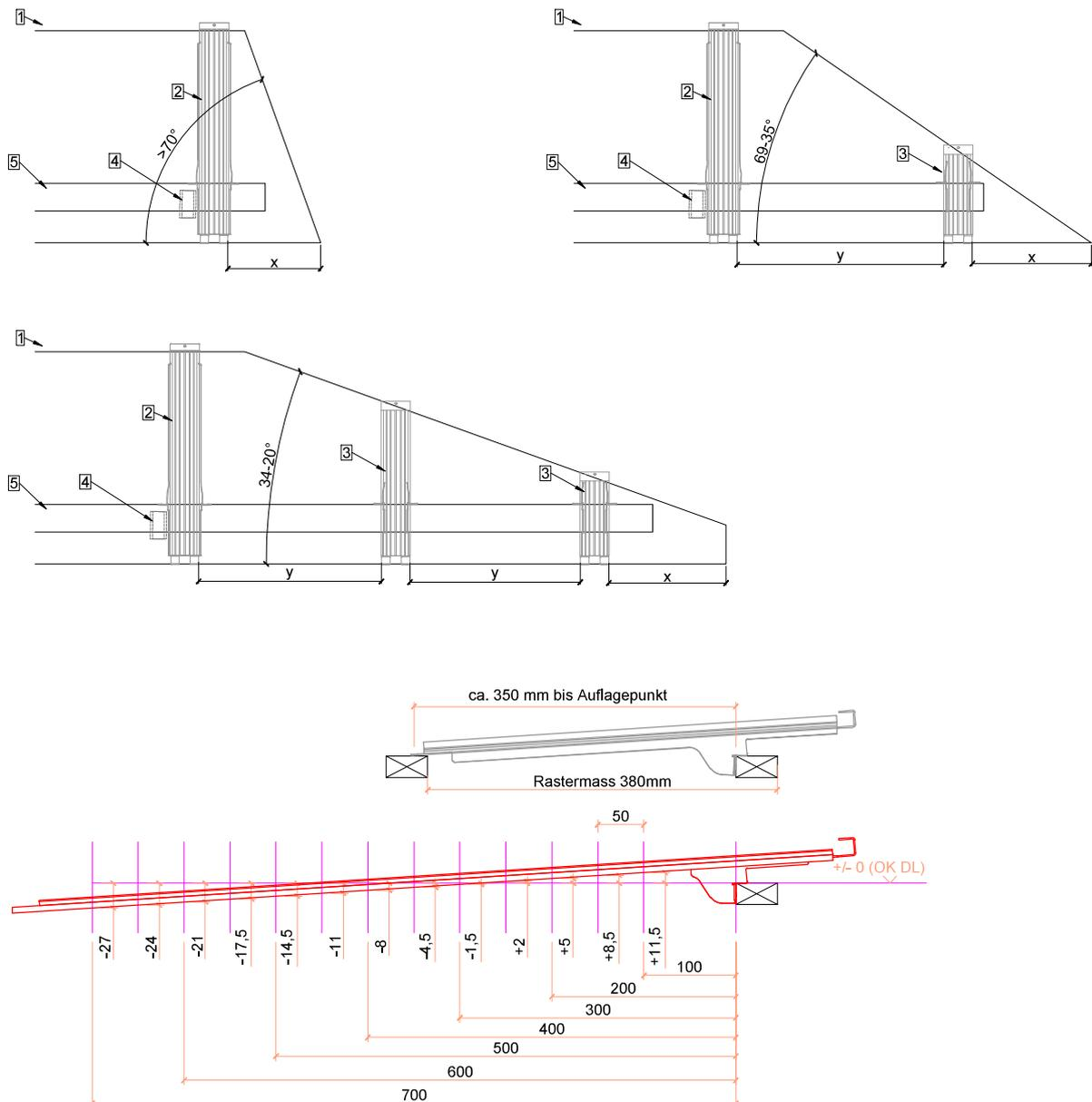
Die Auslegung der MATCH Slate Haken muss dem Modulwinkel angepasst werden.
