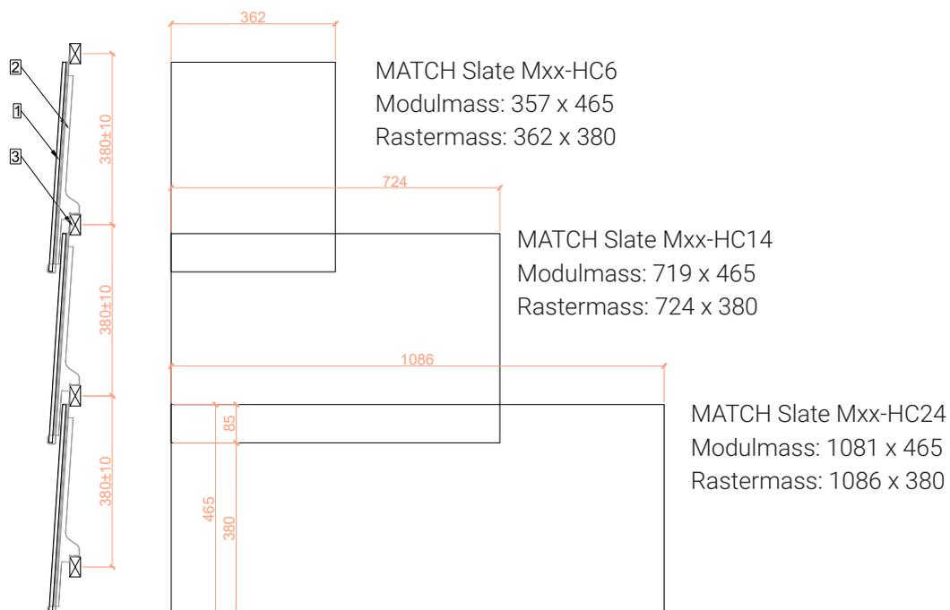
Das Rastermass der MATCH Slate Module ist in der Höhe 380 mm, es kann um  $\pm 10$  mm angepasst werden. Das Rastermass in der Breite lässt sich bis um 10 mm erweitern. Weitere standardisierte Modulmasse sind auf Anfrage ebenfalls erhältlich.
