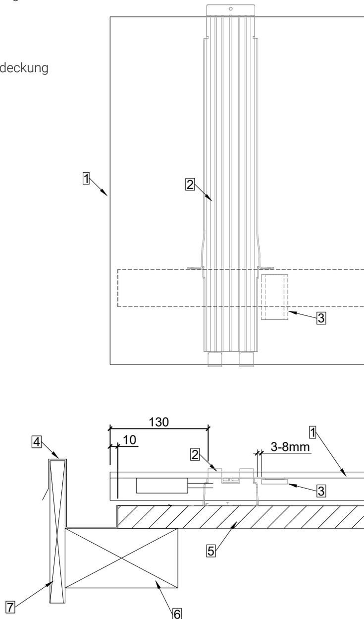
Die MATCH Klebe-Fixierung wird während der Modulmontage angebracht. Klebefläche muss vorgängig gereinigt werden.
