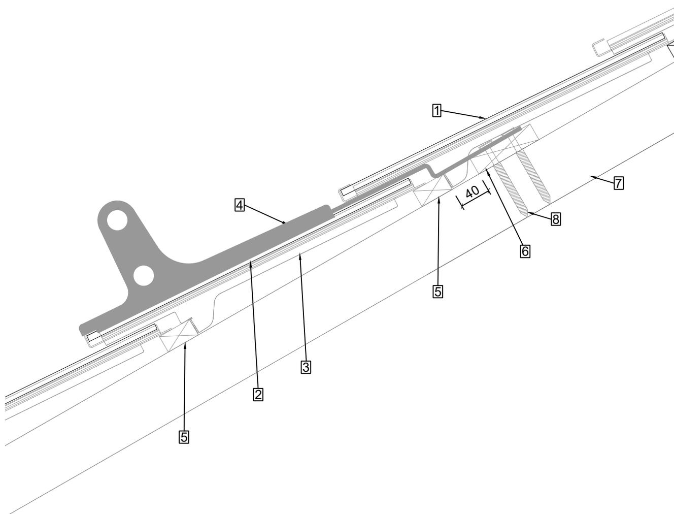
Der MATCH Schneefang im Feld wird jeweils über Blindmodulen, Inshapeplatten oder inaktiven Modulen montiert. Unter jedem MATCH Schneefang im Feld muss direkt darunter oder unmittelbar daneben ein MATCH slate Haken u/z montiert werden, um die Schneelast auf die Unterkonstruktion zu übertragen.
