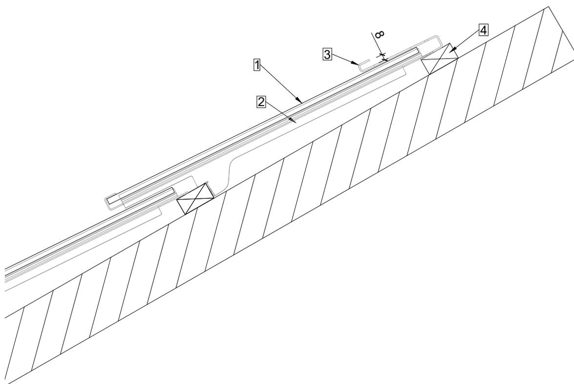
Module, die nicht genügend mit einem darüberliegenden MATCH Slate Haken gesichert werden, können mit dem MATCH Slate Firsthaken gegen Windsog gesichert werden.
