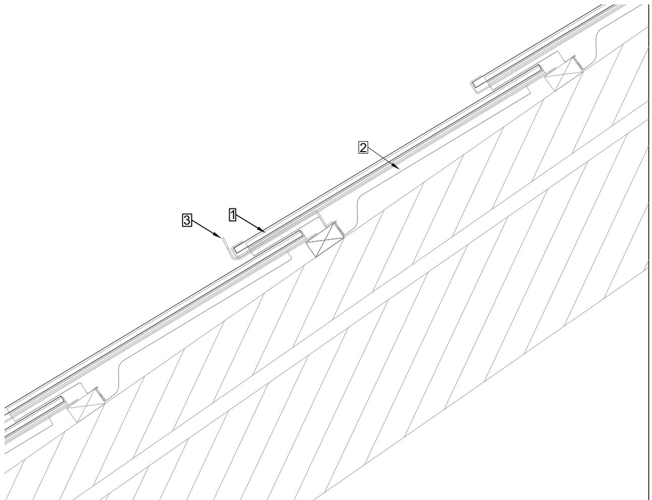
Der MATCH Slate Schneestopper wird jeweils über einem MATCH Slate Haken z / u montiert.
