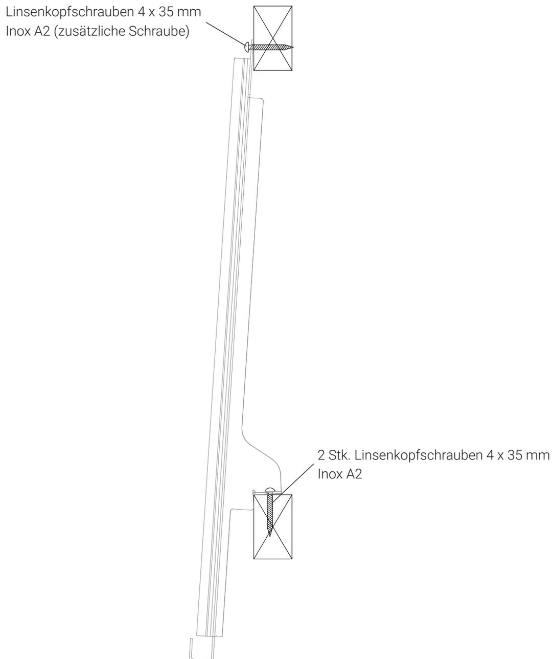
Die MATCH Haken werden jeweils mit 2 Schrauben auf der Dachlattung festgeschraubt. Die Schraube oben kann zusätzlich angebracht werden, empfohlen ist diese vor allem in den obersten Reihen und in den Randbereichen. Wir empfehlen die Dachlattung sowie die Konterlattung zu verschrauben. Die Statik des gesamten Dachaufbaus ist Sache des Unternehmers.
